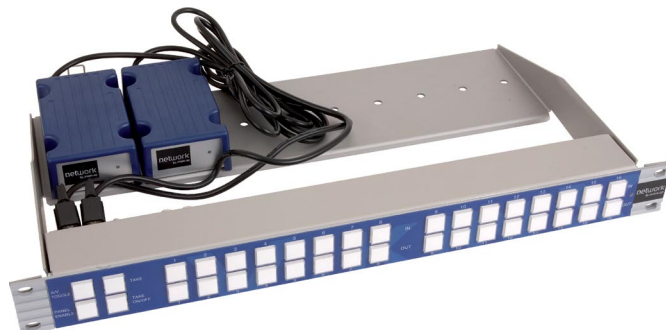
SL-MT-2PSU 1RU 2x SL-PWR-40安装架, 可装在VikinX Sublime矩阵后面
